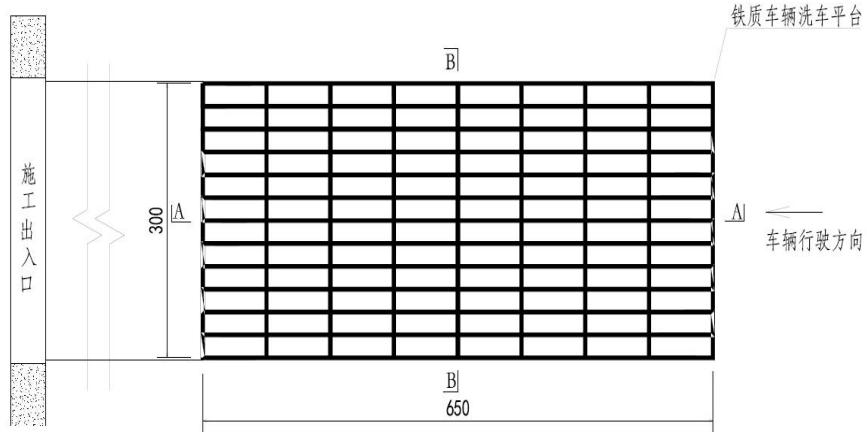
图 3.1 洗车槽平面图
