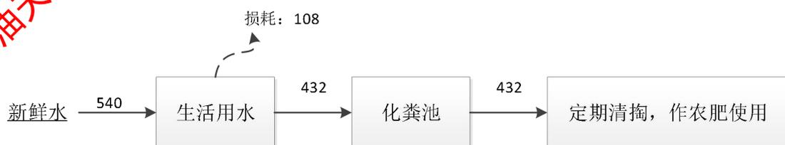
图2-1 项目水平衡图(单位: m<sup>3</sup>/a)
